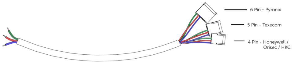
**YOU MUST POWER DOWN THE CONTROL PANEL AND DUALCOM PRO 2 BEFORE CONNECTING THE SERIAL LEAD TO AVOID DAMAGE**
